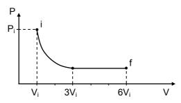
Sabendo-se que a energia interna de um gás ideal é proporcional à sua temperatura absoluta, a energia interna do gás no estado final f é:
